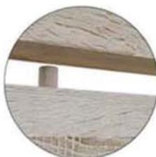
Die Prismen, aus denen das Beet besteht, sind durch Schrauben miteinander verbunden. Die Verbindung ist nicht sichtbar, weil wir einen getrockneten Eichenstift auf den Kopf der Schrauben setzen. Es dehnt sich dann aus, indem es natürliche Feuchtigkeit aus der Umgebungsluft aufnimmt, und die gesamte Verbindung vollständig stark ist.
