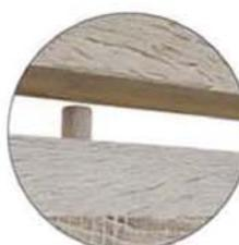
Die Prismen, aus denen das Beet besteht, sind durch Schrauben miteinander verbunden. Die Verbindung ist nicht sichtbar, weil wir einen getrockneten Eichenstift auf den Kopf der Schrauben setzen. Es dehnt sich dann aus, indem es natürliche Feuchtigkeit aus der Umgebungsluft aufnimmt, und die gesamte Verbindung vollständig stark ist.
