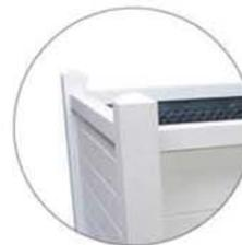
Die Blumentöpfe sind innen mit chemikalienbeständiger Noppenfolie, Kunststofffüßen für maximale Produktlebensdauer ausgestattet. Der Boden ist 3-schichtig, er besteht aus einem massiven Boden mit 5cm dicken Prismen, 3cm extrudiertem Polystyrol und einer Deckfolie. Der Boden ist mit ein oder zwei Überläufen zum Ablassen von überschüssigem Wasser ausgestattet.
